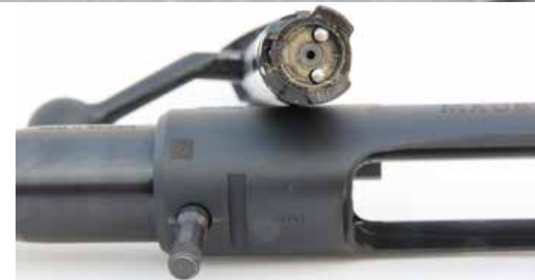
Mauser M18 har sluttstykke med tre låseklakkar, liten utdrager og to utkastarpinnar. Skjefteskruen er festa i låskassen og låskassehalsen har spor for rekyllakk.
